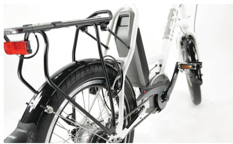
**LINKS** Die wahre „Größe“ des I:SY zeigt sich, wenn der Lenker dank Speed-Lifter werkzeugfrei quergelegt ist und die Faltpedale angelegt sind. Dann macht sich dieses Pedelec sehr schmal und niedrig, so dass es sich leicht beispielsweise in einem Wohnmobil oder einem PKW unterbringen lässt. Aber auch in manchen Garagen oder auch bei der Mitnahme in öffentlichen Verkehrsmitteln kann dies von Vorteil sein.
