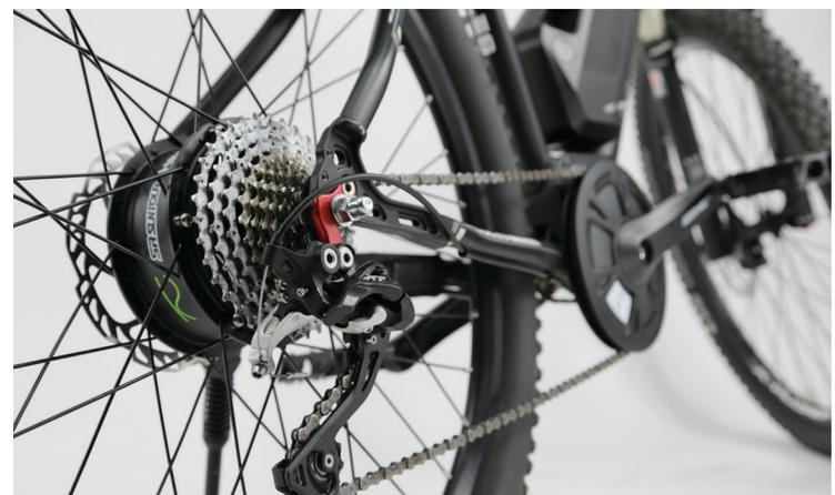
**RECHTS** Der Nabenmotor von SR Suntour ist so klein, dass er kaum hinter dem Ritzelpaket zu erkennen ist. Trotz der geringen Größe ist er angenehm kraftvoll und leiser als die Laufgeräusche der Stollenreifen auf Asphalt. Die Batterie kostet als Ersatzteil fast ein Drittel des Fahrzeugpreises, hat mit 615 Wh aber auch eine stattliche Kapazität, die sich entsprechend in den gemessenen Reichweiten zeigt.
