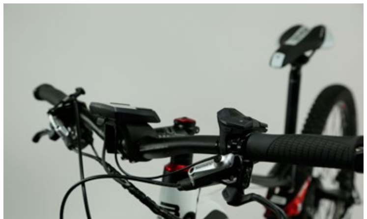
RECHTS Die Entwickler haben bei der Kabelführung am Lenker dafür gesorgt, dass er aufgeräumt aussieht. Auch die Innenverlegung im Unterrohr ist für die Lebensdauer von Vorteil. So sind die Kabel und Schläuche vor Umwelteinflüssen gut geschützt. Der Schiebemode-Taster an der Bosch Lenkerbedienung ist im Gelände nicht sehr hilfreich. Während man den Lenker fest im Griff hat, kann man ihn schlecht drücken.
