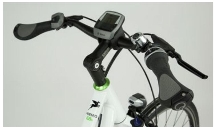
**RECHTS** Alle Funktionen am Lenker des erklärten sich den Testfahrern schnell von alleine. Die Shimano 8 Gang Nabenschaltung mit Rücktritt zusätzlich zu den beiden Magura Hydraulikbremsen sorgt bei vielen Nutzern für das Extra an Sicherheitsgefühl. Für den Komfort sorgen die Ergon Komfortgriffe mit Handballenauflege.
