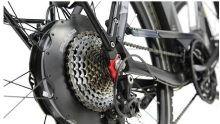
**RECHTS** Der von Alber hergestellte getriebelose und völlig lautlose Hinterradmotor zeigte im Test mal wieder, wie leistungsfähig er ist. Mit einem Unterstützungsfaktor auf der Tour von 2,38 und am Berg und in der Stadt von 1,57 schob er das *Lavida Plus* stärker an, als alle Fahrzeuge seiner Produktgruppe geschoben wurden. Die kräftige Unterstützungsleistung ging dank 615 Wh Batterie aber nicht auf Kosten der Reichweite.
