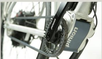
Selten und alles andere als preiswert ist die Kombination aus GO SwissDrive Nabenmotor, Riemenantrieb und dem in seiner Art einmaligen 18 Gang Schaltgetriebe im Tretlager von Pinion, einem kleinen schwäbischen Hersteller.
