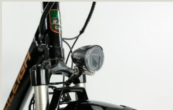
Der Lenker-Kabelsalat ist hier in zwei Stränge zusammengefasst und wird seitlich in den Rahmen eingeführt.
