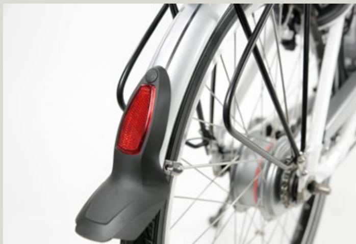
Die C-Serie im Test schaltete stufenlos mit der NuVinci Nabenschaltung. The C-Series on test had stepless gear-shifting thanks to the NuVinci hub gear.
