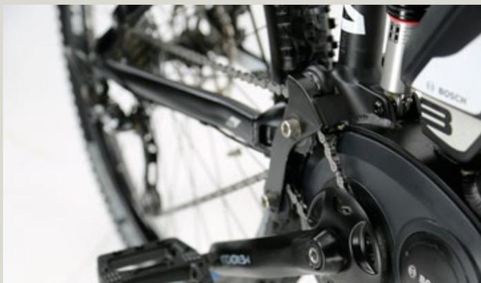
Sieht gewagt aus. Die Kettenführung des Bulls SIX50 EFS 3 MTB sorgt aber auch bei wilden Manövern dafür, dass die Kette auf den Ritzeln bleibt und nicht abspringt. *The chain routing on the Bulls SIX50 E-FS 3 MTB looks radical, but it does ensure that the chain stays on the sprocket without jumping off even through the wildest of manoeuvres.*
