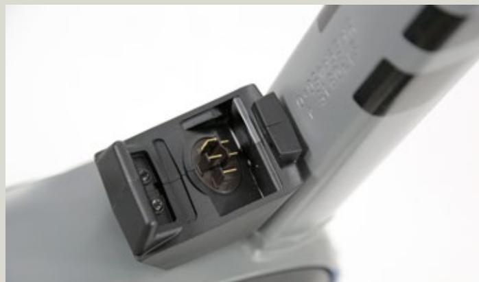
Das Xduro RX 29 mit der 2. Generation des *Bosch* Antriebs mit neuem deutlich kleineren Stecker wie hier vom Fahrzeug zum Aufsteckakku. Vom Ladegerät zum Akku ist der Stecker identisch.
