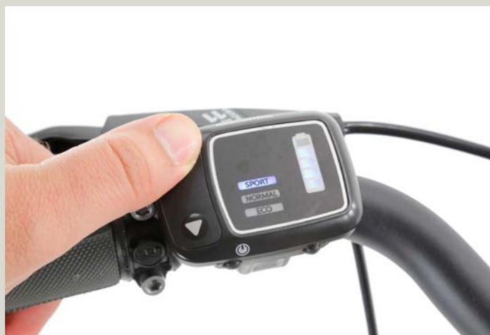
Einfach und Gut das Bedienfeld des Giant Twist. Im Mittelpunkt stehen die beiden Menüasten Auf und Ab die mit dem Daumen leicht zu erreichen sind. Lediglich der zierliche An- und Ausschalter am unteren Gehäuserand will gesucht werden.
