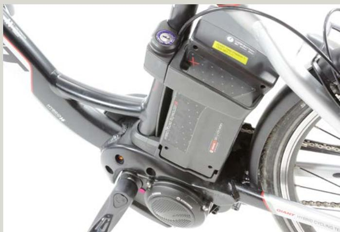
Der Mittelmotor vom Erfinder des Pedelec Mittelmotors – der Firma Yamaha – mit zentral platzierter Batterie treibt das Twist Freedom an. Die Abschliessbare Batterie lässt sich leicht herausnehmen.
