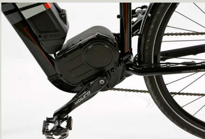
Der Motor ist so angeordnet, dass sich die Bodenfreiheit wie bei einem normalen Fahrrad über die tiefste Stelle des Kettenblattes definiert. In unwegsamem Gelände kann dies von Vorteil sein.
