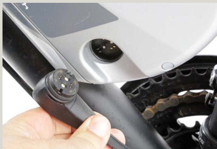
Die Batterie wird entweder mit dem Ladegerät oder mit dem Antrieb über einen EnergyBus Beta Magnetstecker verbunden.
