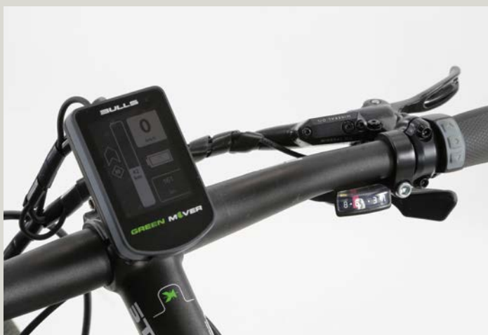
Abnehmbarer Display mit intuitiver Menüführung gesteuert über die Fernbedienung die direkt neben dem Lenkergriff montiert ist.
