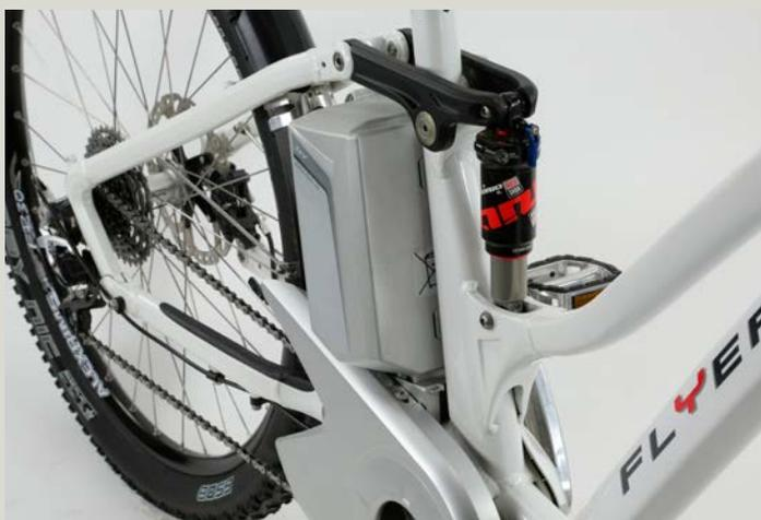
Vollfederung und Mittelmotor wie zentrale Batterieposition sind nicht einfach von der Konstruktion. Hier sieht man nachvollziehen, wie sich die Entwickler bei Flyer ins Zeug legen mussten, um eine sinnvolle Lösung zu finden.
