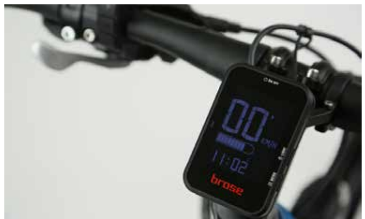
RECHTS Das vom Automobilzulieferanten Marquardt hergestellte Display ist recht kompakt und flach, so dass es beim Transport in der Hosentasche nicht stört. Es zeigt die wichtigen Informationen, wie Geschwindigkeit und Batteriekapazität, deutlich und groß an. An der Lenkerhalterung ist zudem eine USB-Ladebuchse untergebracht, über die beispielsweise ein Mobiltelefon geladen werden kann.
